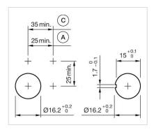
$\begin{array}{l} \mathsf{A} = \text{Solder/Plug-in terminal 2.8 mm x 0.5} \\ \mathsf{mm} \\ \mathsf{C} = \text{Screw terminal} \end{array}$
